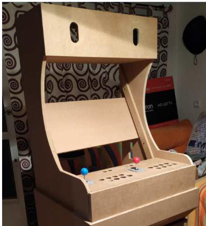
Figura 4. Máquina Arcade en proceso de construcción
