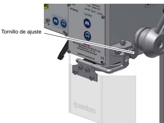
Fig. 1-3: Dispositivo protector separador
